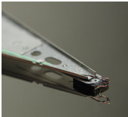
Cabezal magnético de un disco duro.
